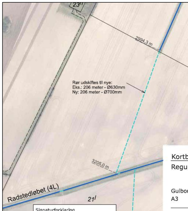
Billede 3 4L2 - Kort fra ansøgningsmaterialet. Lyseblå stiplet linje er den eksisterende rørlægning der ønskes udskiftet.
