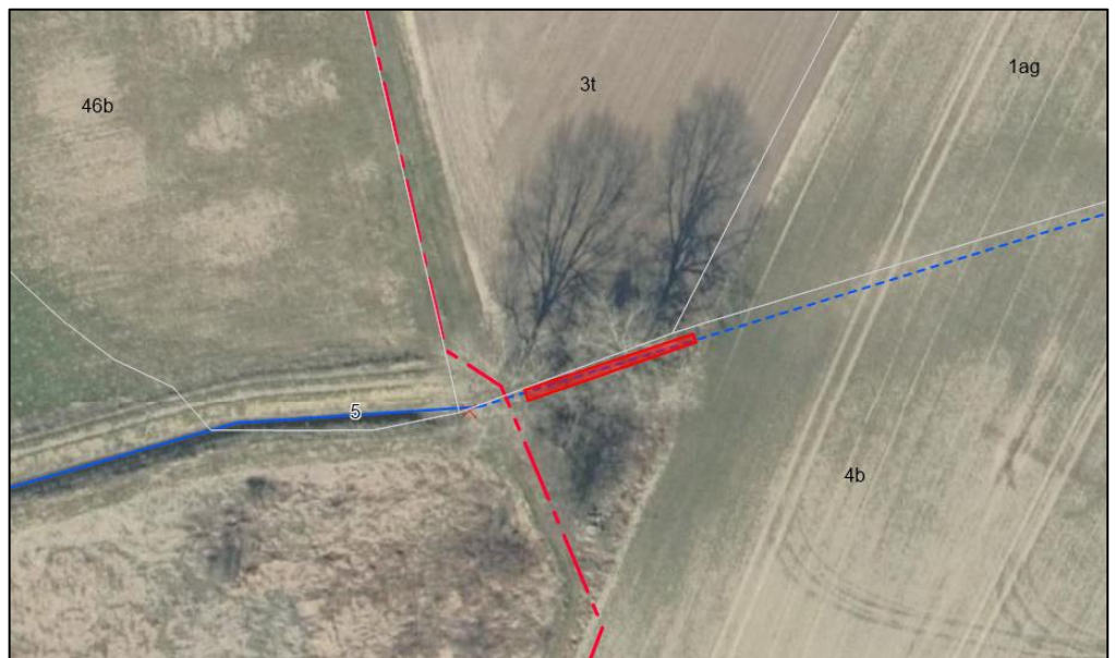
Billede 2 Matrikelkort over projektet. Den røde markering viser det rørlagte trace der ønskes åbnet. Den rød stiplede linje er Forsyningens trykledning.
