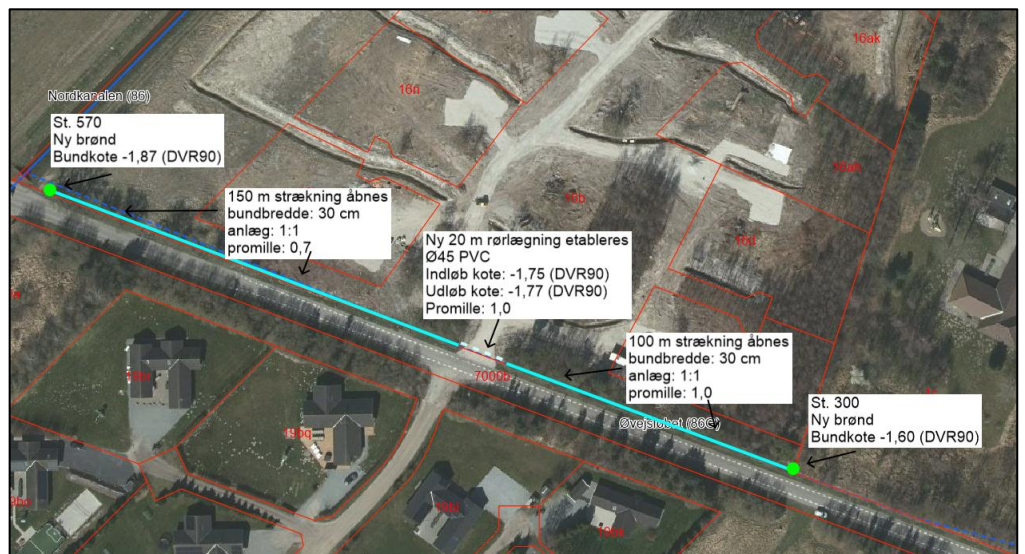
Figur 2 Projektbeskrivelse. Den blå linje er hvor vandløbet bliver åbnet op og den stiplede linje er en ny rørlægning, under den nye indkørsel til sommerhusområdet.
