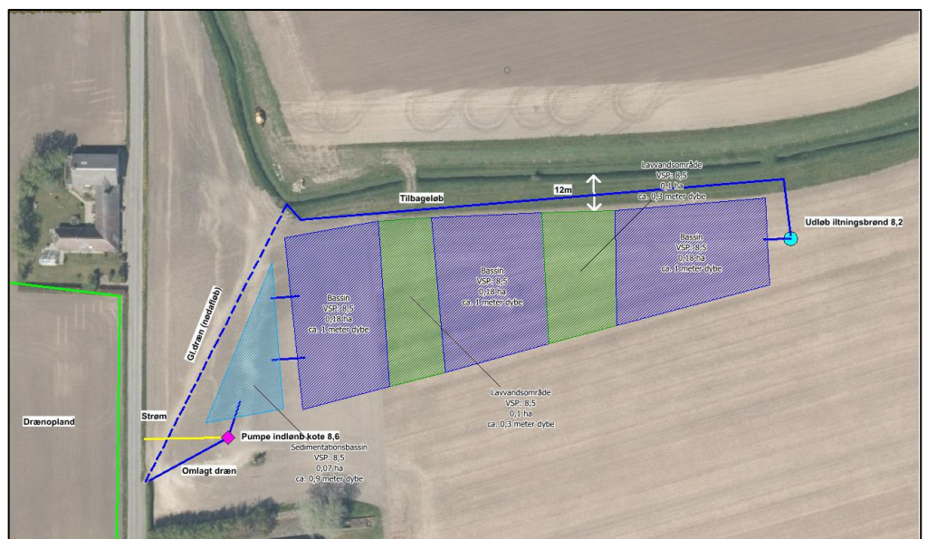
Billede 2: Detaljeret oversigt over minivådområdets udformning
