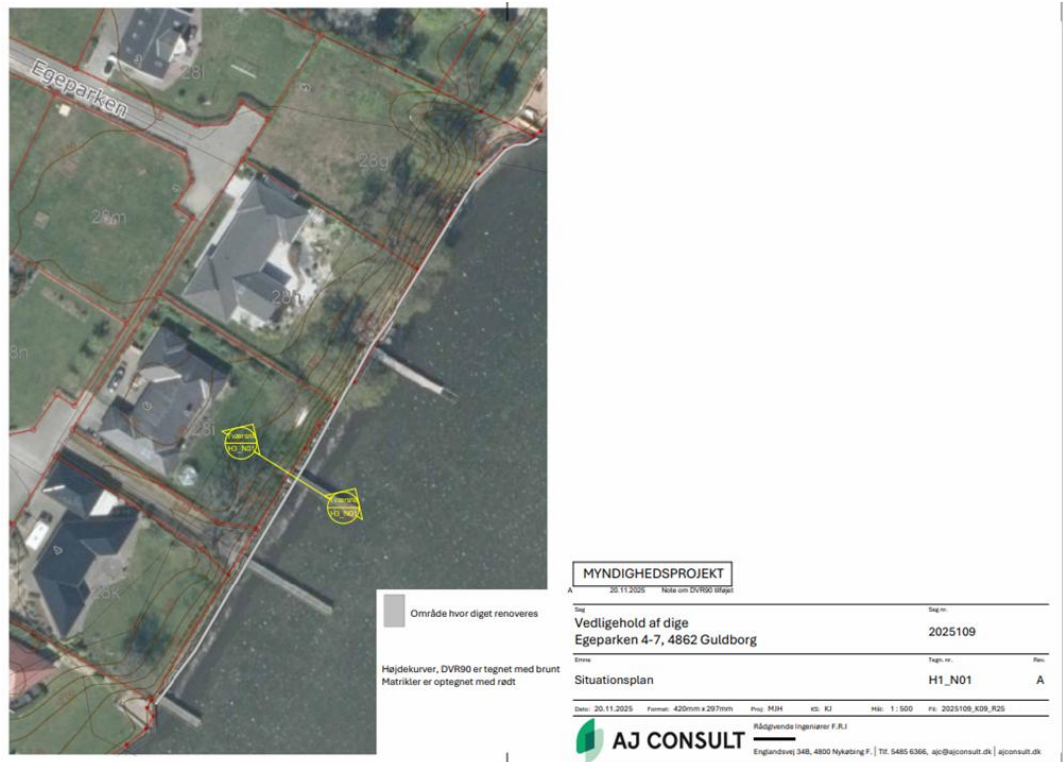
Området ud for de fire ejendomme, hvorstensætningen renoveres, er angivet med grå signatur – Fra ansøgningsmaterialet
