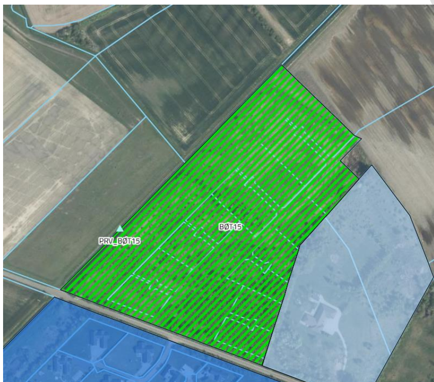
Figur 10 Kloakopland BØT15 med separat regnvandsudløb PRV_BØT15
