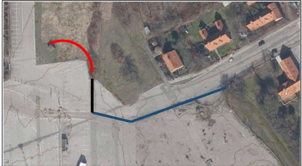
3:B. Principudformning af det nye Kystbeskyttelses anlæg med beskrivelse (Kilde: SWECO). Blå streg er højvandsmur, sort streg er vejbump og rød streg er jorddige.
