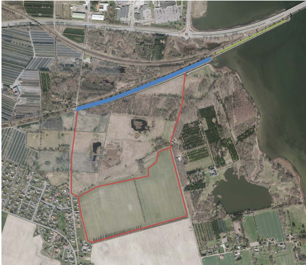
Figur 1: Blå streg: jordarbejder, grøn streg: spunsarbejder, rød streg: afgrænsning af byggeplads og veje
